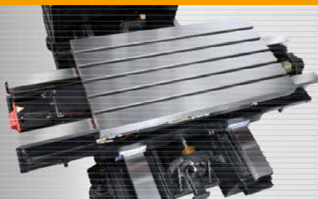
■ 一體式馬達座/軸承座，與鑄件滑軌形成封閉力流滿足機台高剛性
